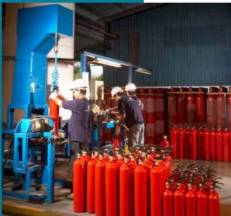
▲ CO2 Fire Extinguisher Filling
