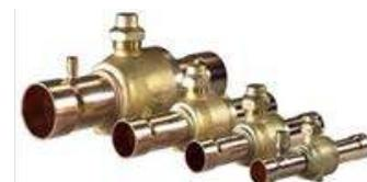
สำหรับการดำเนินงานในช่วงอุณหภูมิที่กว้างและได้รับการรับรองให้ใช้กับสารทำความเย็น fluorinated ใดๆ ก็ได้ Ball Valve มาตรฐานอาจถูกนำมาใช้ในการใช้งานโดยใช้สารทำความเย็นแรงดันสูงรวมทั้ง R410A สำหรับการใช้งาน CO<sub>2</sub> สามารถใช้ได้กับความดันสูงสุดถึง 90 บาร์ (1300 psig)
